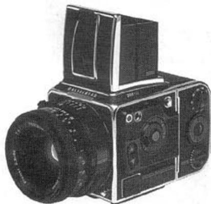
Plačiajuostis fotoaparatas "Hasselblad" su keičiama kasete. Kasetė kartu su fotojuosta yra atskiriama nuo kameros korpuso ir, esant reikalui, gali būti pakeista atsargine kasete su kitokia fotojuosta
